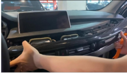
4. Entfernen Sie die Luftauslassblende
