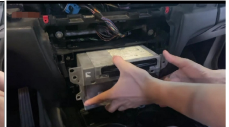
12. Ziehen Sie den Original-Host des Fahrzeugs
