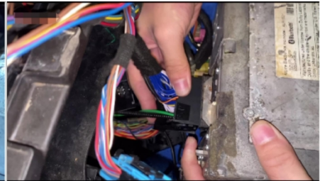
21. Stecken Sie das neue Netzkabel in den Original-Host des Fahrzeugs
