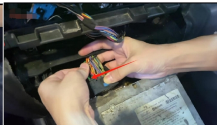
14. Ziehen Sie das Glasfaserkabel ab.
