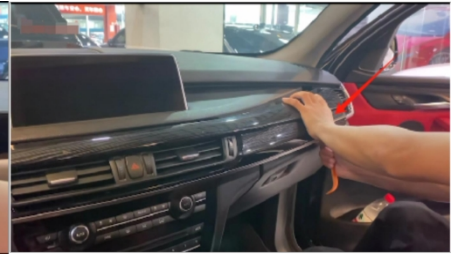
3. Entfernen Sie die Luftauslassblende
