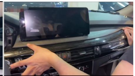
39. Installieren Sie die Rückluft-Auslassblende
