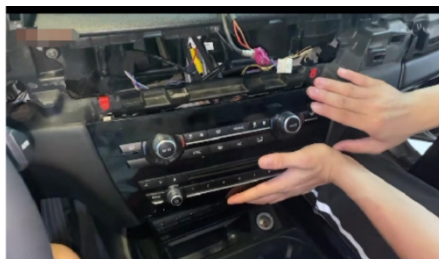
28. Bringen Sie die Tastenleiste der Klimaanlage wieder an
