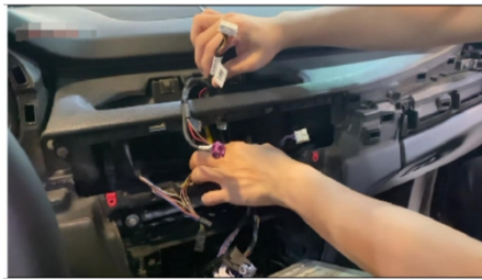
19. Das Netzkabel verläuft vom Host zur Position des Bildschirms
