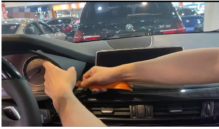
1. Entfernen Sie die Schutzabdeckung des Armaturenbretts
