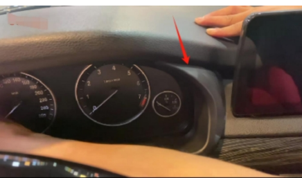
40. Die Schutzabdeckung des Armaturenbretts wieder anbringen
