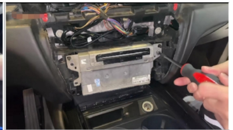
24. Drehen Sie zurück die Schrauben (des) CD Host
