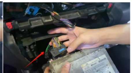
15. Ziehen Sie das Glasfaserkabel ab.
