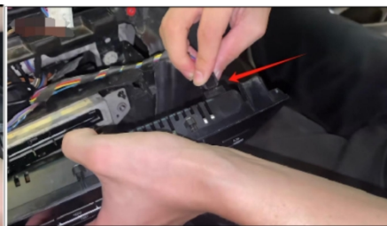
26. Installieren Sie den Rücklaufanschluss
