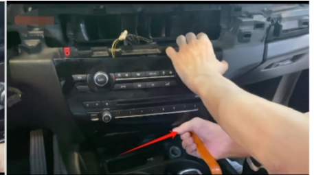
9. Entfernen Sie die LuftkonditionierungTaste Blende
