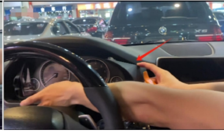
2. Entfernen Sie die Schutzabdeckung des Armaturenbretts
