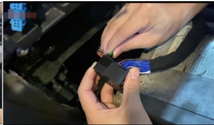
20. Stecken Sie das Original-Glasfaserkabel des Fahrzeugs in unser Kabel
