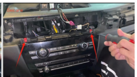
30. Setzen Sie die beiden Schrauben wieder ein
