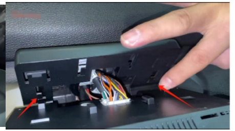
35. Installieren Sie das Stromkabel für den Bildschirm
