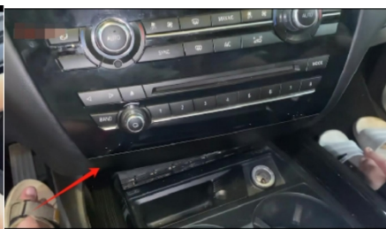
29. Bringen Sie die Bedienblende der Klimaanlage wieder an
