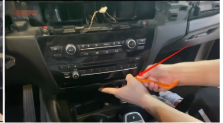
6. Entfernen Sie die (Klimaanlagen-)Taste Blende
