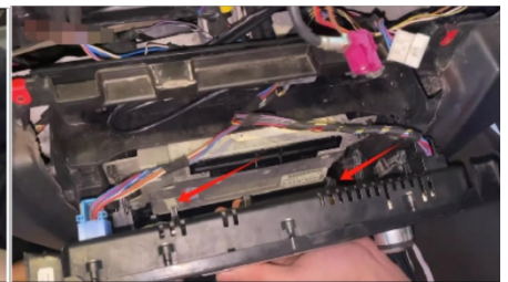
27. Ausrichten mit dem Kartenschlitz
