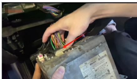
13. Ziehen Sie das Netzkabel hinter dem Host ab
