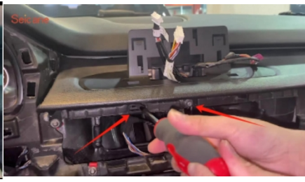
32. Drehen Sie die Schraube zurück
